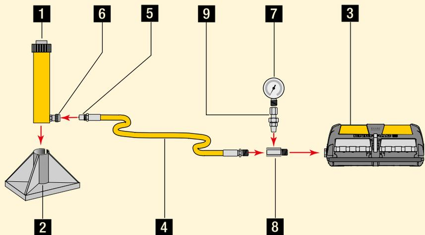
**Система с цилиндром двустороннего действия** используется для подъема грузов, при котором требуется медленное контролируемое опускание.
